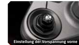
Einstellung der Vorspannung vorne
